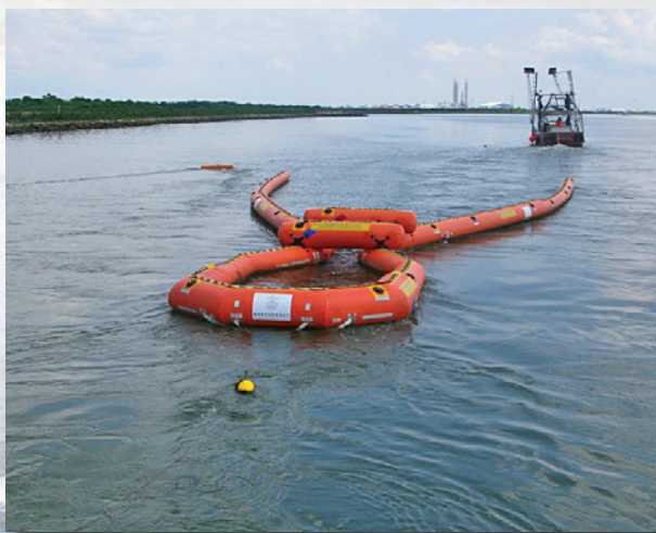
Los sistemas "Harbour Busters" demostraron ser muy efectivos durante la respuesta Macondo mejorando la tasa de recuperación mar adentro.
